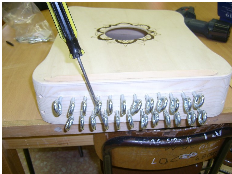
Si avvitano gli occhielli per metterle in tensione
