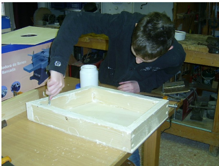
Fase di incollaggio del telaio e delle basi
