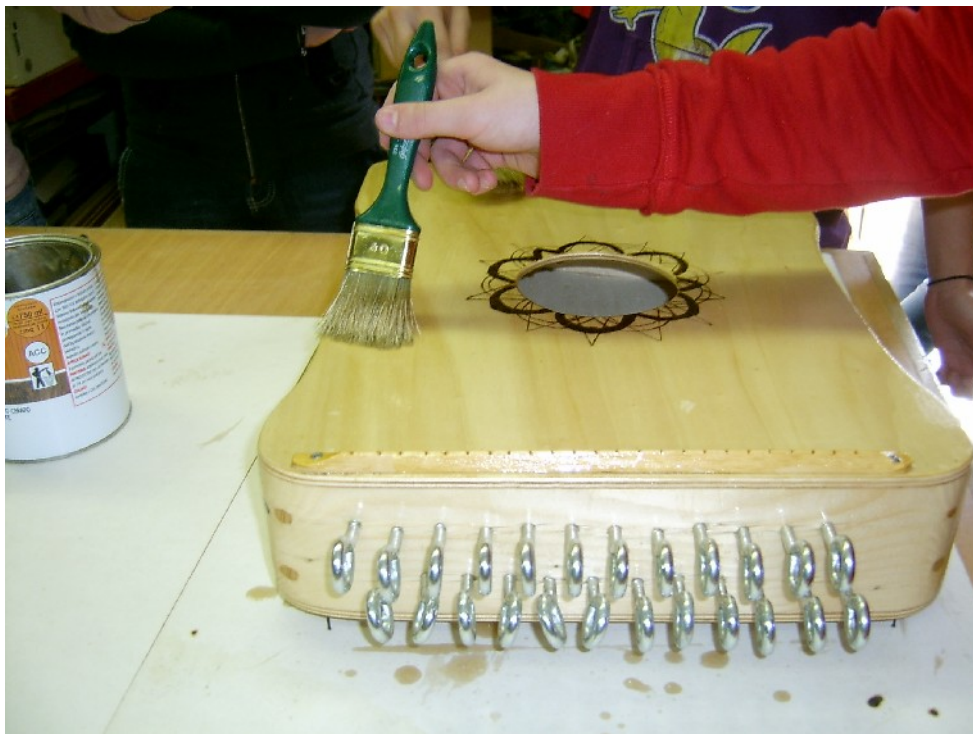
Tocco finale la vernice trasparente: due mani; poi rifinitura con paglietta d'acciaio e infine si da la cera.
