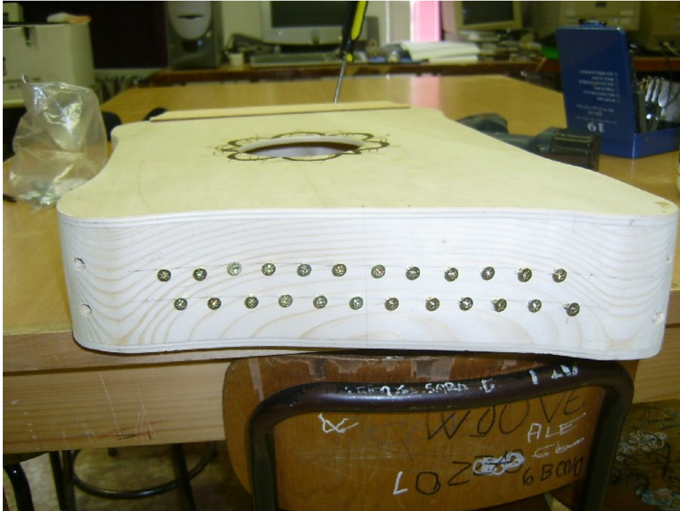
Si inseriscono le viti per il fissaggio delle corde
